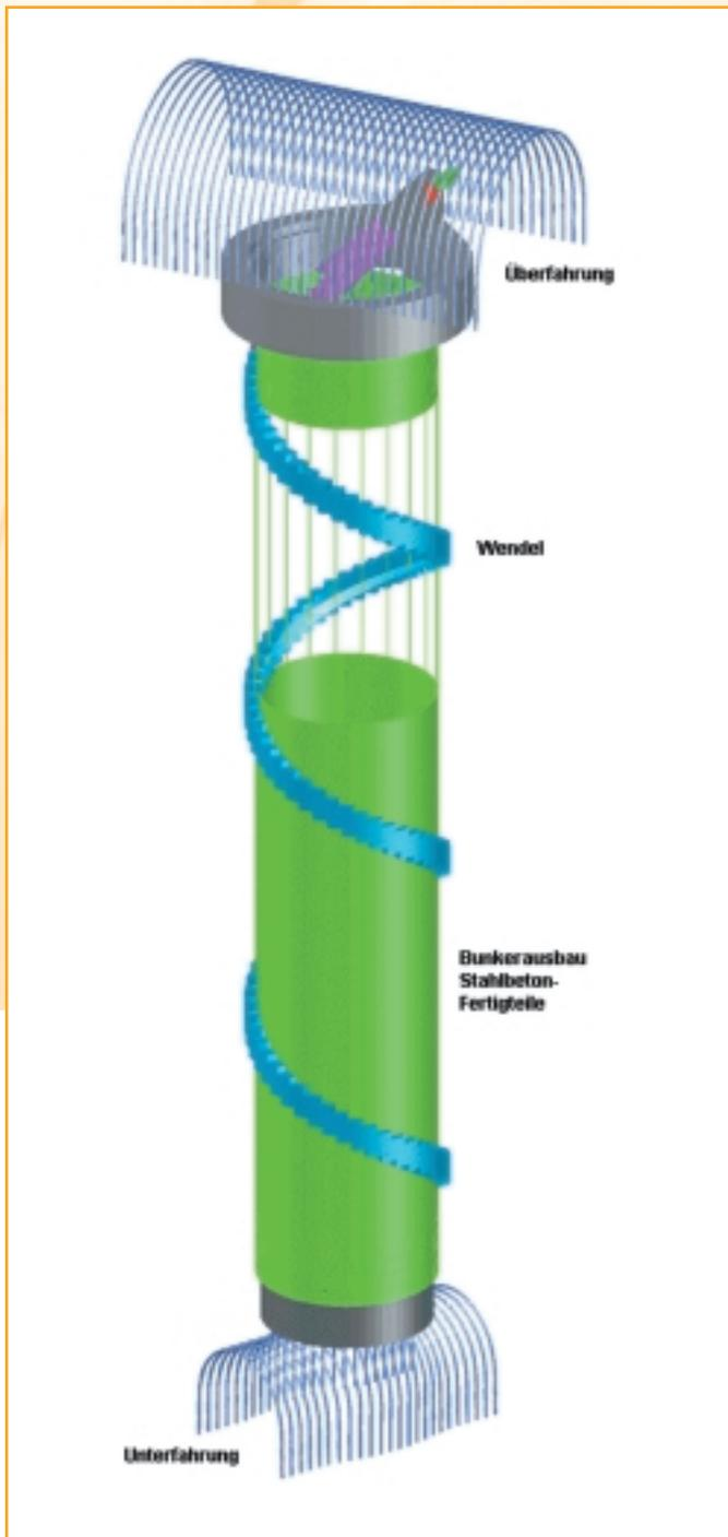
Für den Betrieb des Bergwerks hat der Bunker einen hohen Stellenwert. In ihm laufen alle Förderströme des Bergwerks zusammen, bevor sie über den Von-Oeynhausen-Schacht nach über Tage gefördert werden. Bei einem Durchmesser von 9 m und einer Teufe von 61 m kann der Bunker etwa die halbe Tagesförderung (2000 m<sup>3</sup>) des Bergwerks aufnehmen. Dadurch
