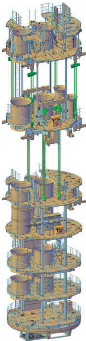
Схема 7-ми-этажного проходческого полока: рабочий и несущий модули
